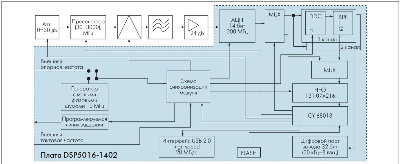
Рис. 1. Функциональная схема приставки РЧ-3200 на основе платы DSP5016-1402
