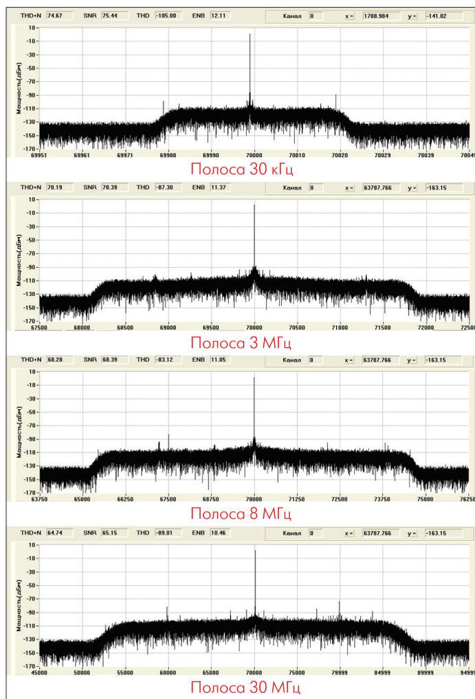
**Рис.2. Спектральные характеристики платы DSP5016-1402 в зависимости от выбранной полосы одновременного анализа. Видно, что при сужении полосы растет мгновенный динамический диапазон и соотношение сигнал/шум, что позволяет работать с сигналами с большей амплитудной разницей**
