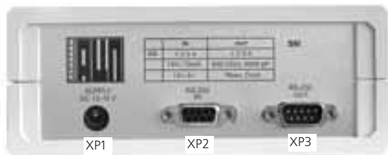
Рис. 6. 2 Задняя панель прибора
